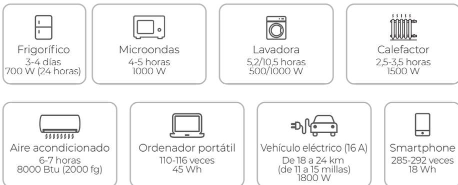
$6144 \text{ Wh}^* \times \text{DoD} \times \eta \div (\text{potencia de carga}) = \text{tiempo de carga (aproximado)}$
