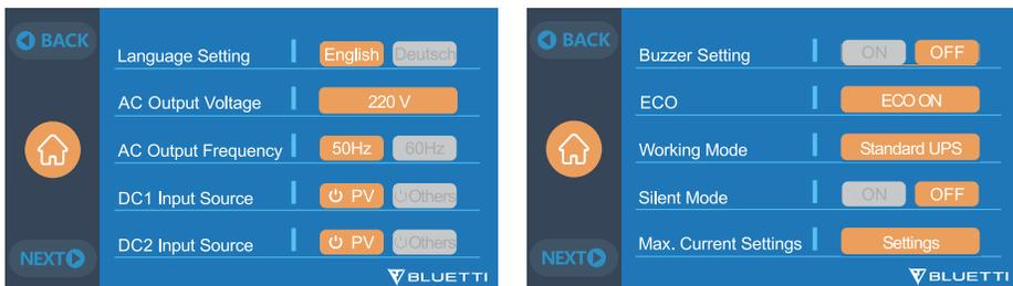
**Nota:** Compruebe la configuración al completo antes de usarlo por primera vez. La frecuencia y el voltaje de CA solo se pueden ajustar después de apagar la salida de CA.
